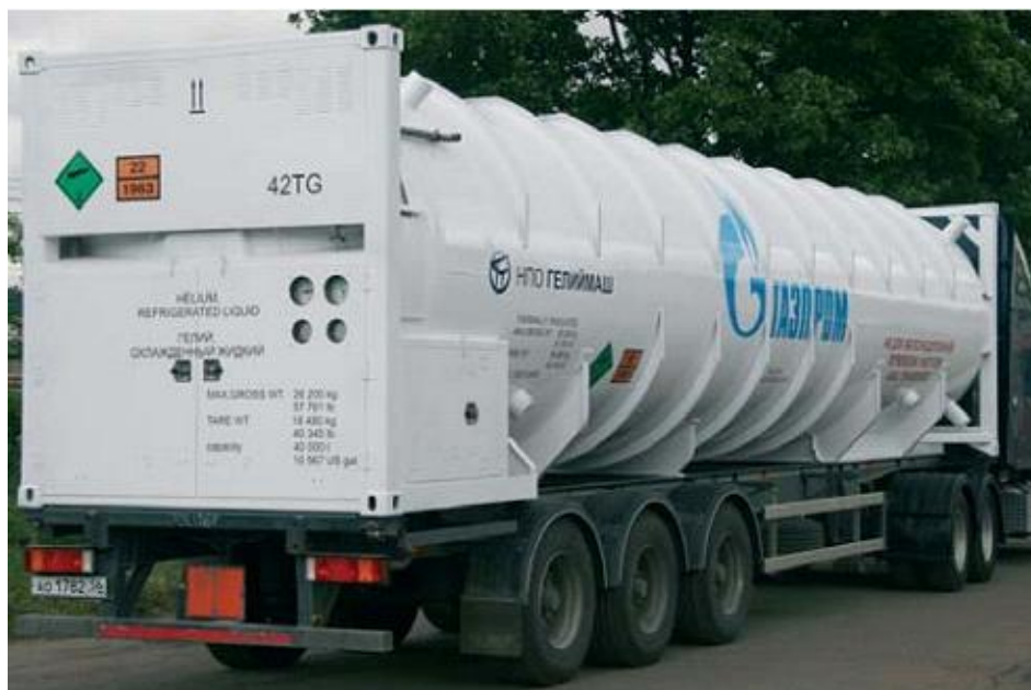
Рис. 11.6.1. Общий вид транспортного резервуара 40 м 3
