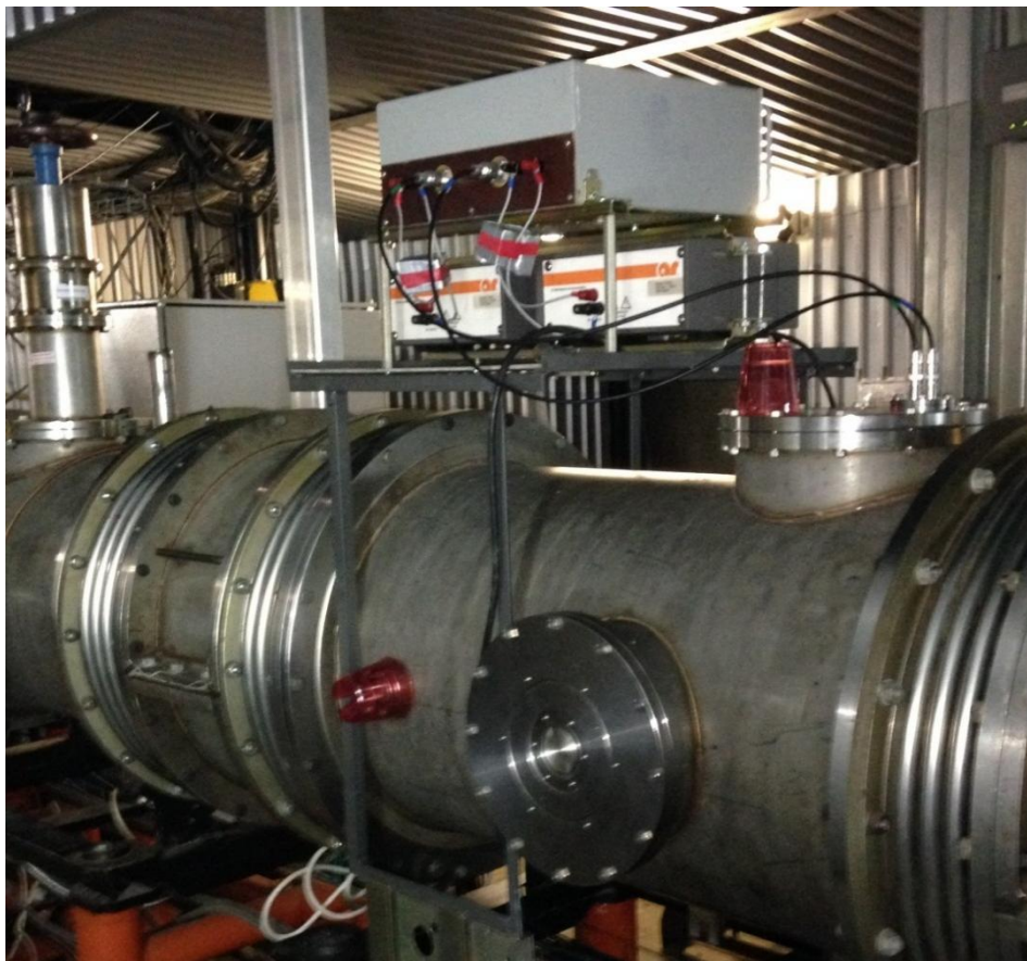
Рис. 8.1.22. Участок кикеров на кольце Нуклотрона
