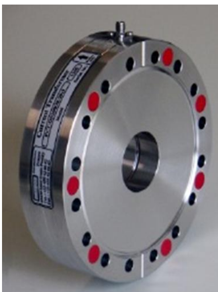
Рис. 8.1.7. Быстрый трансформатор тока для установки в вакуумную камеру
